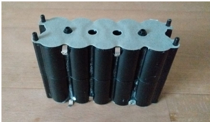
Batterimodul. Indeholder 10 stk. 18650 celler
